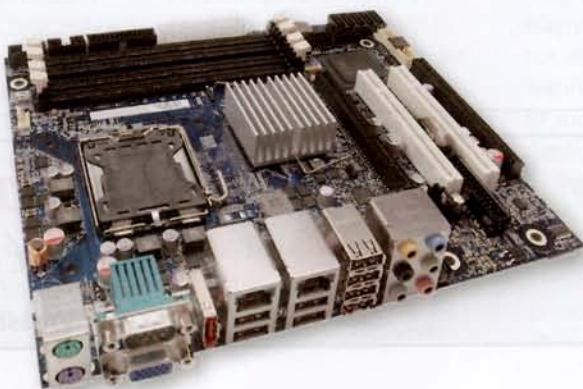
Das embedded Motherboard KTQ45 unterstützt neueste Management Technologie dank Intel AMT 5.0 und dem integrierten Intel Trusted Platform Module (TPM 1.2).
